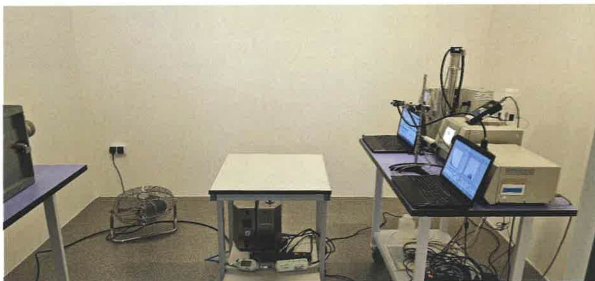
Rysunek 2.1. Widok stanowiska badawczego do badania emisji nanocząstek z próbek lamp
